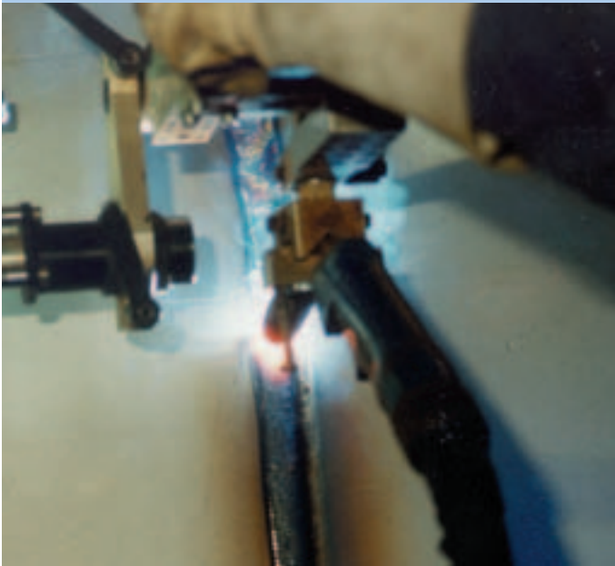
使用伯乐EAS 4 PW-FD进行机械化焊接
