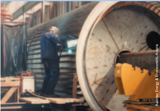
造纸业脱水过滤装置 使用伯乐EAS2-FD (母材1.4306/AISI 304L)
